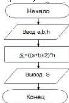
Рисунок 1. Блок-схема линейного алгоритма
