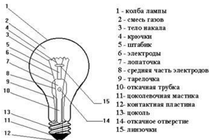
Рис. 3. Устройство лампы накаливания
