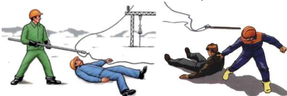
Рис. 3. Способы освобождения пострадавшего при напряжении выше 1000 В
