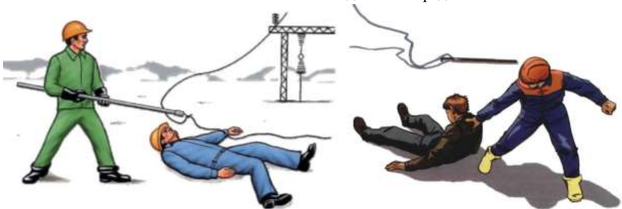
Рис. 3. Способы освобождения пострадавшего при напряжении выше 1000 В
