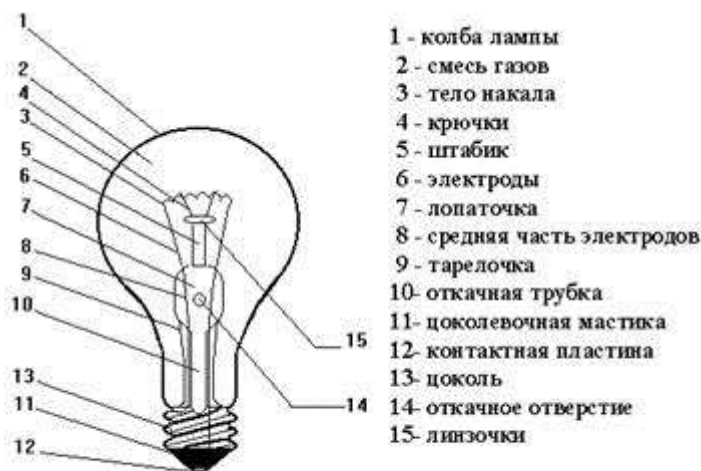
Рис. 3. Устройство лампы накаливания
