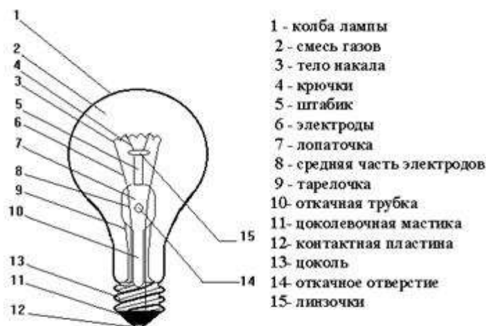
Рис. 3. Устройство лампы накаливания
