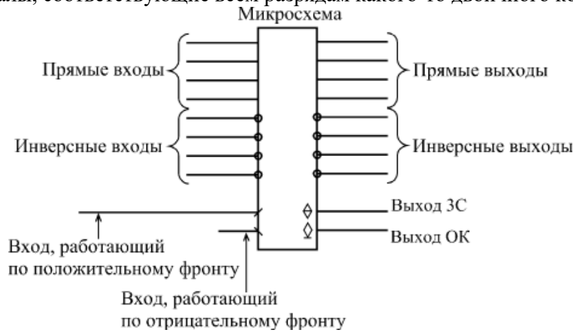
Рис. 2. Обозначение входов и выходов
