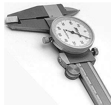
Рисунок 1 - Штангенциркуль со стрелкой на круговой шкале
