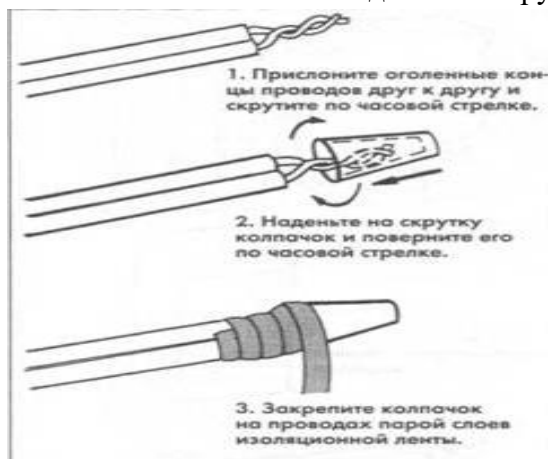
Рисунок 2 – Соединение жил кабеля
