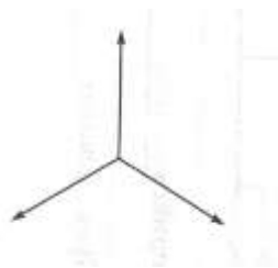
Рис. 6.1. Векторная диаграмма напряжений и токов трехфазной ЭЦ с равномерной нагрузкой однофазных приемников, соединенных «звездой» (строится при подготовке к работе).
