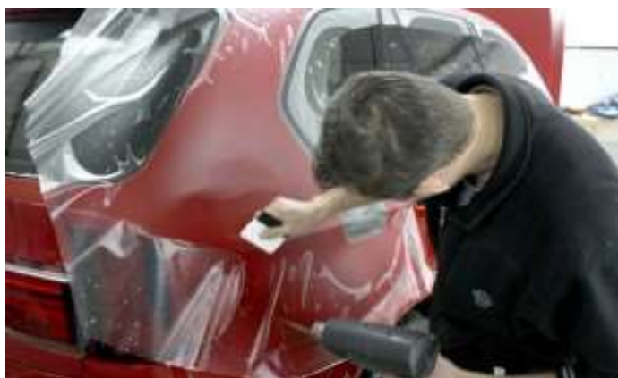
Рис. 2. Защитные пленки от коррозии
