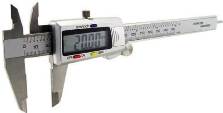
Рисунок 2 – Штангенциркуль с цифровой индикацией
