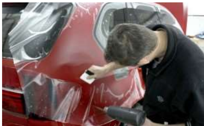
Рис. 2. Защитные пленки от коррозии
