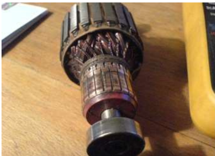
Коллектор со стертыми ламелями
