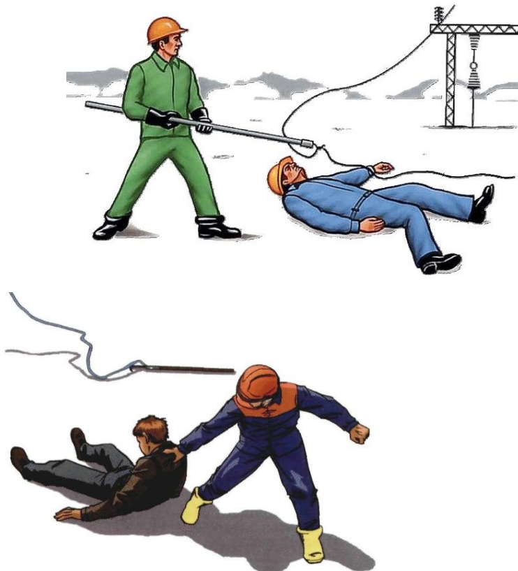
Рис. 3. Способы освобождения пострадавшего при напряжении выше 1000 В
