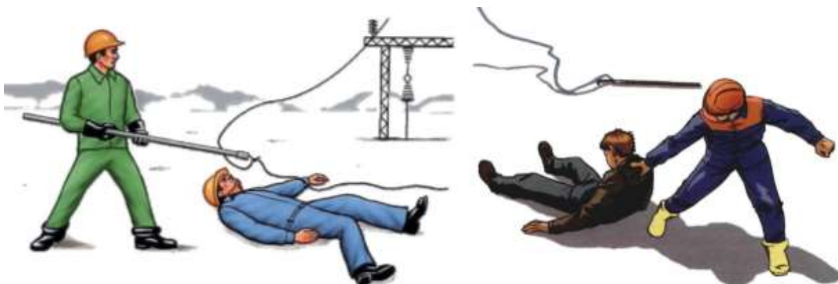
Рис. 3. Способы освобождения пострадавшего при напряжении выше 1000 В
