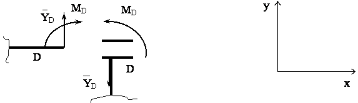
Рис. 16. Разбиение конструкции на два тела в точке D , т. е. в месте их соединения скользящей заделкой (трение в ней не учитывается)
