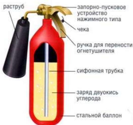
*Углекислотный огнетушитель* эффективно работает всего 40-6-сек, поэтому при тушении пожара надо действовать быстро и энергично. Весовая проверка углекислотных огнетушителей проводится не реже одного раза в три месяца, а освидетельствование с гидравлическим испытанием – через пять лет. Запорное и предохранительное устройства углекислотных огнетушителей пломбируются.
