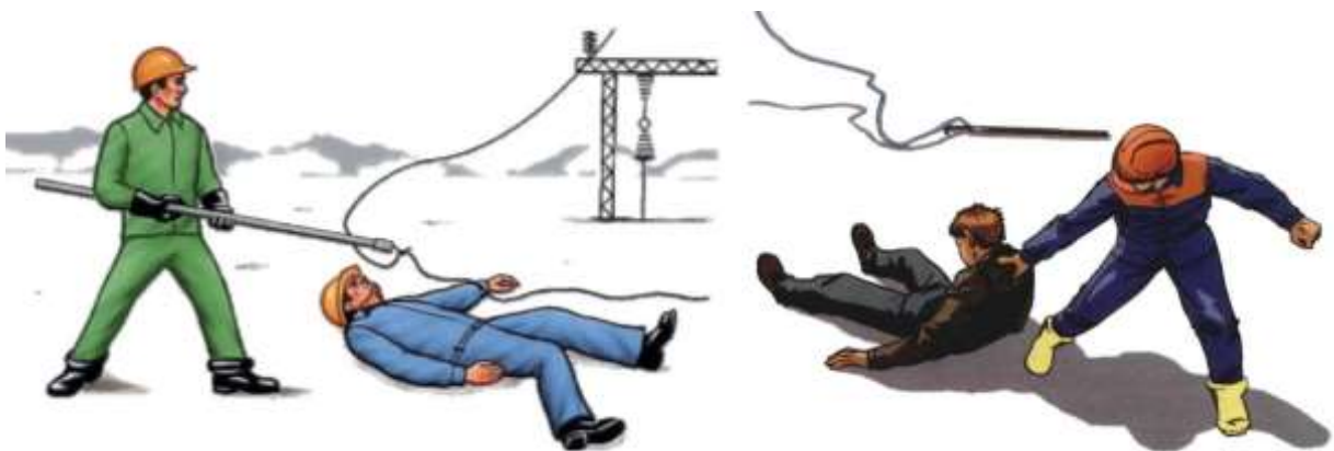
Рис. 3. Способы освобождения пострадавшего при напряжении выше 1000 В
