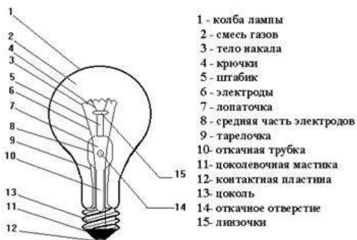
Рис. 3. Устройство лампы накаливания
