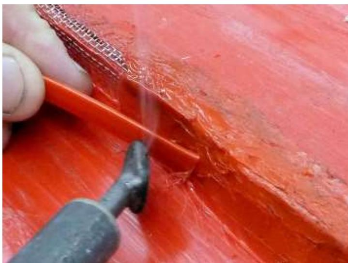
Рис. 5. Склеивание пластмассы
