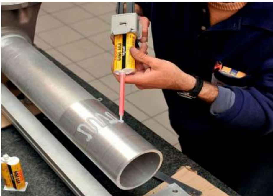
Рис. 4. Склеивание металла
