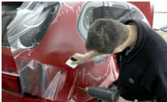
Рис. 2. Защитные пленки от коррозии
