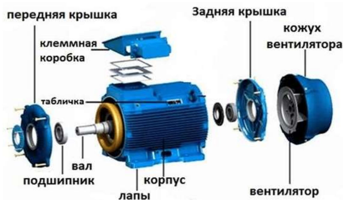
Устройство асинхронного электродвигателя
