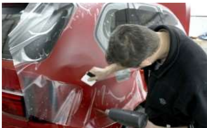
Рис. 2. Защитные пленки от коррозии
