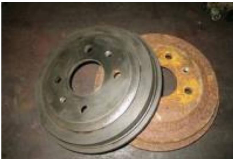
Рис.4. Фосфатирование стальных поверхностей
