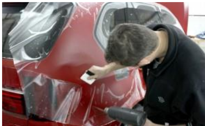
Рис. 2. Защитные пленки от коррозии
