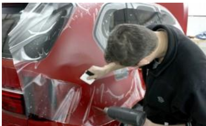
Рис. 2. Защитные пленки от коррозии
