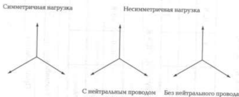
Рис. 7.2. Векторная диаграмма трехфазной ЭЦ с активной нагрузкой однофазных приемников, соединенных «звездой» (строится по результатам испытаний)
