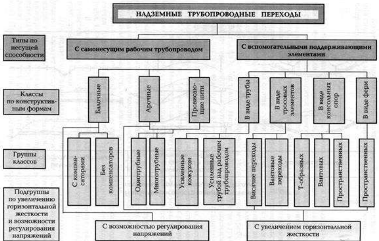
Рисунок 2 Классификация надземных трубопроводных переходов по конструктивным признакам
