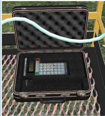
Рисунок 2. Считыватель показаний Microstt-a во взрывозащищенном кейсе
