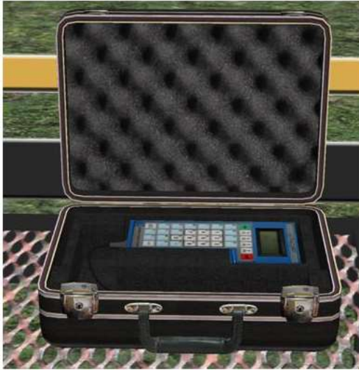
Рисунок 10. Считыватель показаний UltraCorr -а во взрывозащищенном кейсе
