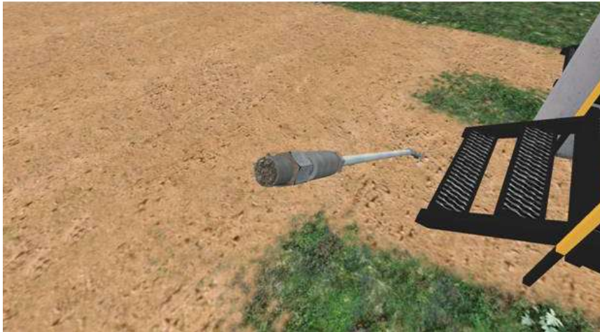
Рисунок 4. Установка "образцы свидетели коррозии" (забитые песком)
