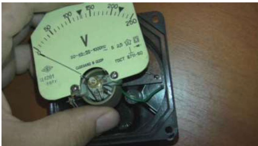
Изображение смещения стрелки и винта, с помощью которого она регулируется
